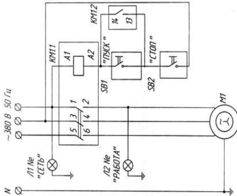
Рис. За. Принципиальная электрическая схема КИД-60
