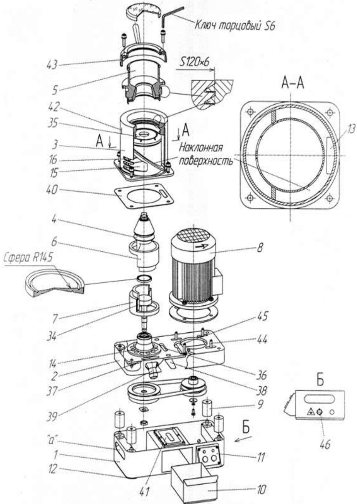
Рис. 1. Общий вид КИД-60 (разнесенный вид)
