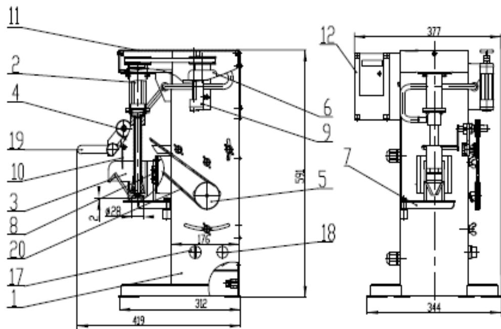
1 – Корпус; 2 – Блок импеллера; 3 – Камера; 4 – Пеногон; 5 – Привод пеногона; 6 – Двигатель привода импеллера; 7 – Столик; 8 – Направляющее устройство; 9 – Ротаметр; 10 – Лопатка; 12-Блок управления (ВПЧ); 17-Переключатель; 18-Лампа; 19-Штанга; 20-Пассик.
