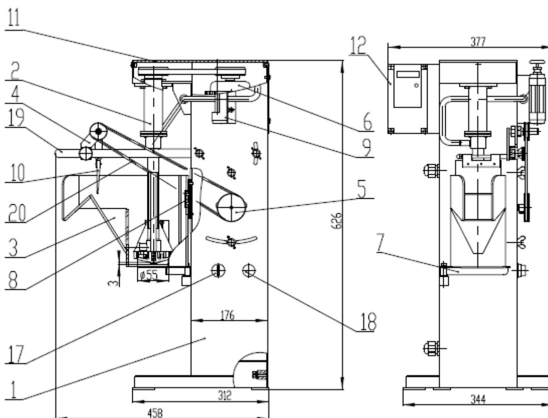
1 – Корпус; 2 – Блок импеллера; 3 – Камера; 4 – Пеногон; 5 – Привод пеногона; 6 – Двигатель привода импеллера; 7 – Столик; 8 – Направляющее устройство; 9 – Ротаметр; 10 – Лопатка; 12-Блок управления (ВПЧ); 17-Переключатель; 18-Лампа; 19-Штанга; 20-Пасик.
